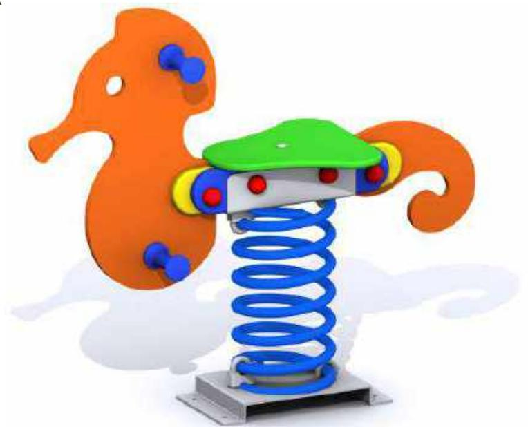
El muelle es de acero diámetro de 20 mm. La superficie se trata después con granalla pretensada con capas de preparación de zinc y 2 capas de polvo de poliéster de 100 micrones. La pieza de fijación en poliamida cargada garantiza una longevidad y una seguridad excepcional al sistema. Las manetas y reposapiés son de plástico poliamida muy resistente. La tornillería en acero inoxidable está protegida por cápsulas anti-vandalismo en poliamida. Altura de caída 50 cm.
